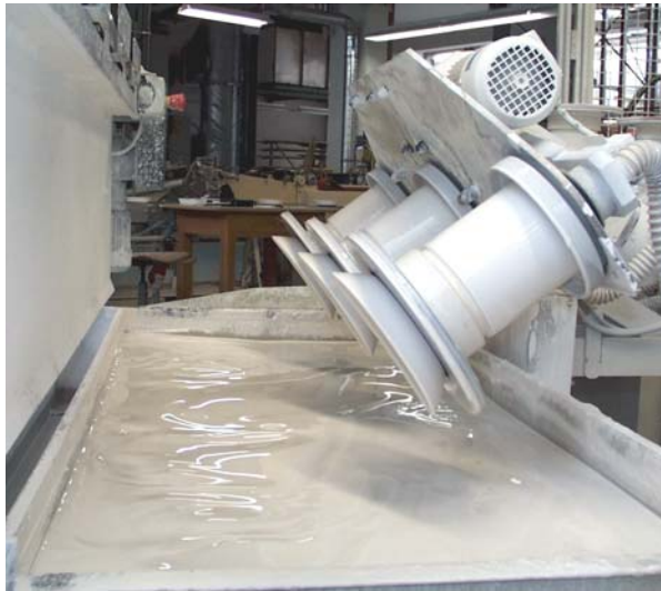
Bild 1: Vertikales Ausheben der Glasurtöpfe bei der neuen Anlage
